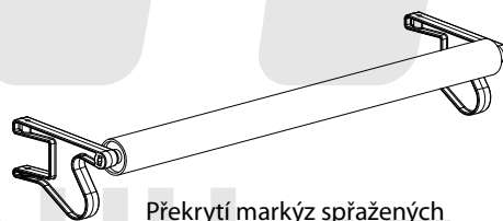
Překrytí markýz spřažených
